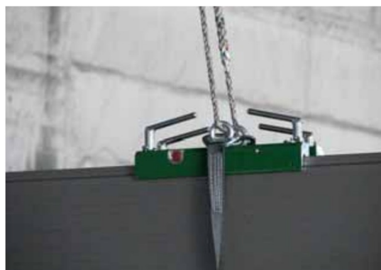
Рис. 2. Монтажный подъемный инструмент для панелей ТПК Веста при размещении в горизонтальном состоянии.
