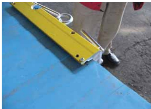
Рис. 4. Монтажный подъемный инструмент для панелей ТПК Веста при размещении в вертикальном состоянии.
