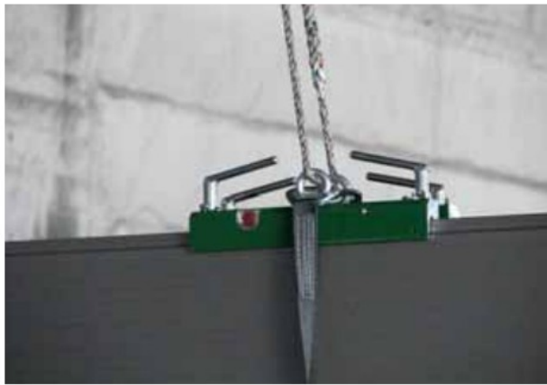
Рис. 14. Подъемный монтажный инструмент для сэндвич-панелей при размещении в горизонтальном положении.
